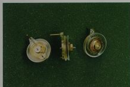
定織度感知器：目的織度に適した厚みを有するゲージ板を2枚の円形ガラスの間にはさんで一定の長さ重量を有する指示棒を取り付けてある。
